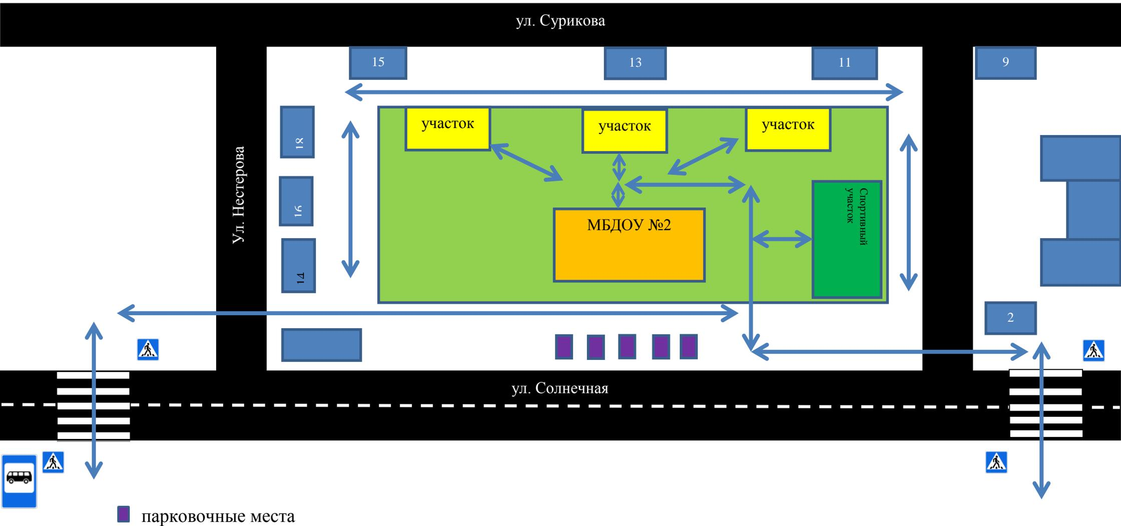
Схема организации дорожного движения в непосредственной близости от ДООУ с размещением соответствующих технических средств, маршруты движения детей и расположение парковочных мест. Корпус Б
